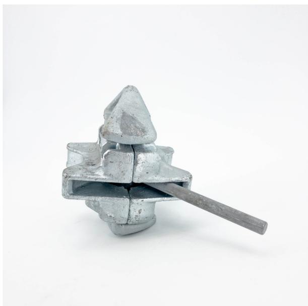
Le twist-lock container est un accessoire indispensable pour le transport maritime. En effet, c'est une pièce de métal qui permet d'unir verticalement deux conteneurs l'un sur l'autre. Résiste aux forces horizontales et de séparation.
